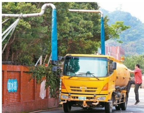
圖 10 水資中心放流水開放取水情形
