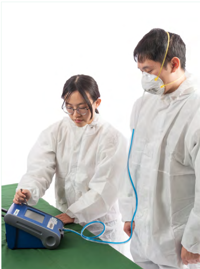
以儀器量測方法進行 N95 ( 半面體呼吸防護具 ) 之定量 密合度測試
